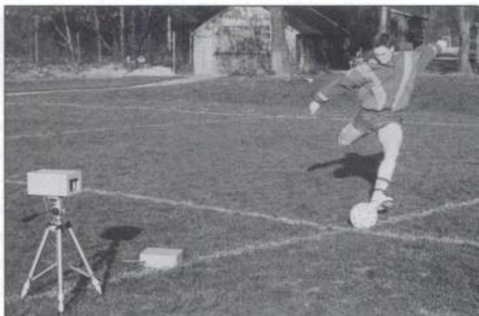
El resultado de los lanzamientos de un jugador puede evaluarse midiendo la velocidad de la pelota después del lanzamiento.
